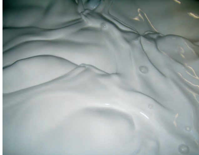
PCM-Slurry in einem Speichertank.
